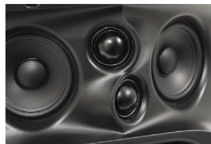
Wyprofilowany front umożliwił skrócenie głośników sekcji średnio-wysokotonowej na zewnątrz, tak by poprawić efekt stereo.
